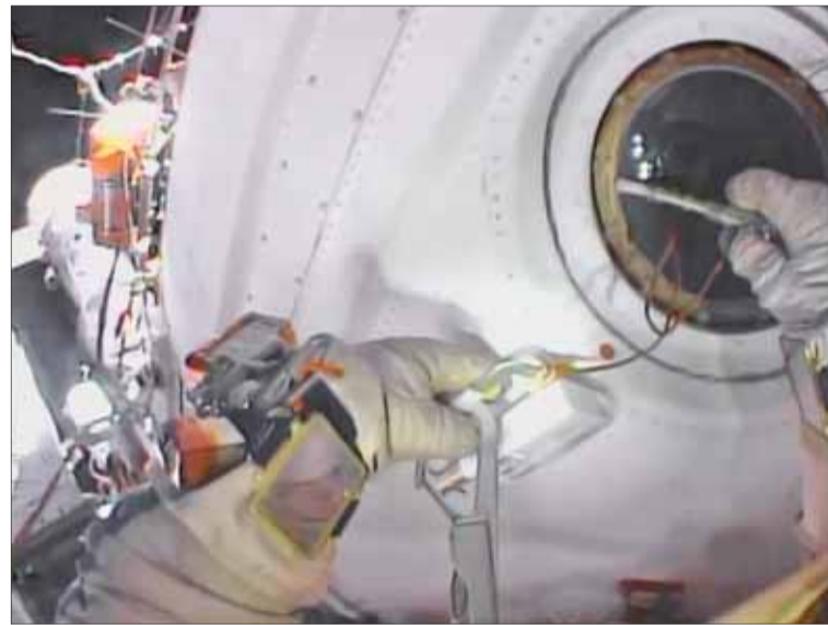
Отбор пробы с иллюминатора.
