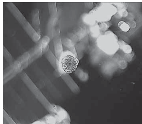
Каверны на стекле иллюминатора от ударов микрометеорита.
