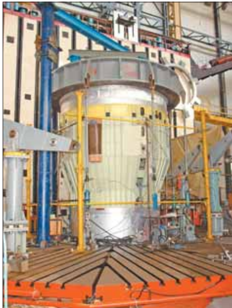
Статические испытания РН «Ангара».
